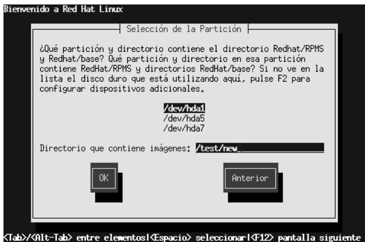
Gráfico 5–5 Selección del diálogo de partición para la instalación del disco duro
